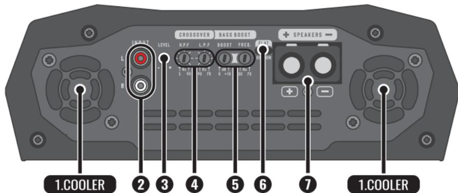
**1. COOLERS:** Eles proporcionam o resfriamento do amplificador. Faça a instalação em local arejado, sem obstrução das entradas e saídas de ar.
