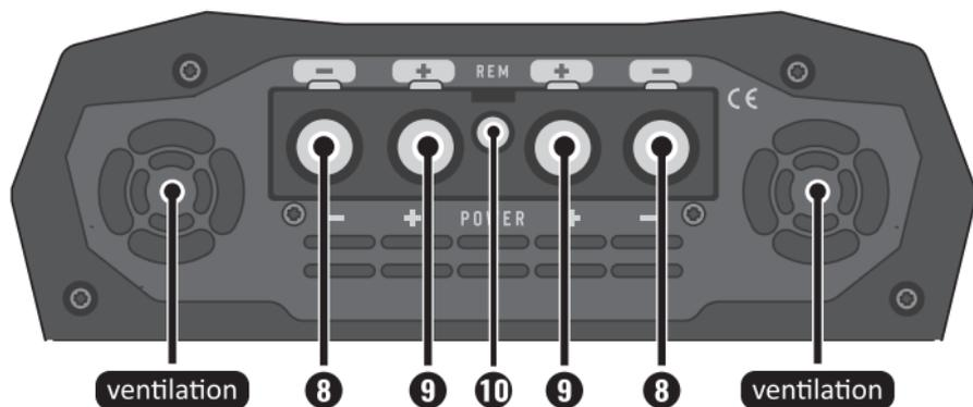
**8. CONNETTORE DOPPIO  $\ominus$  (TERRA):** Effettuare il collegamento con il terminale di terra della batteria utilizzando due cavi di almeno **70mm<sup>2</sup>** con un massimo di 3 metri (uno per ogni ingresso negativo dell'amplificatore).
