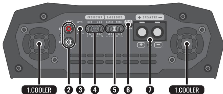
**1. COOLERS:** Proporciona enfriamiento para el amplificador. Realice la instalación en un lugar ventilado, sin obstruir las entradas y salidas de aire.
