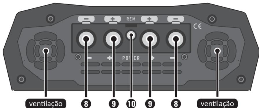
**8. CONECTOR DUPLO  $\ominus$  (TERRA):** Faça a conexão com o terminal terra da bateria utilizando dois cabos com no mínimo **70mm<sup>2</sup>** com até 3 metros (um para cada entrada negativa do amplificador).
