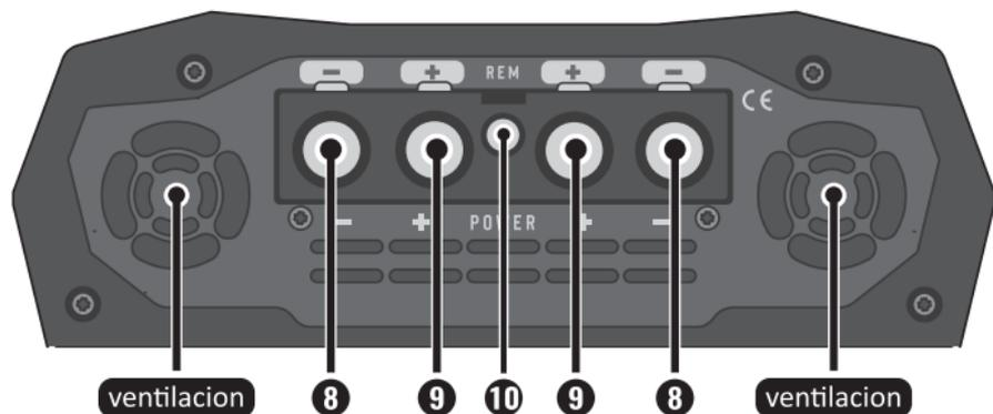
**8. CONECTOR DOBLE  $\ominus$  (TIERRA):** Realice la conexión con el terminal de tierra de la batería utilizando dos cables de al menos **70 mm<sup>2</sup>** con hasta 3 metros (uno para cada entrada negativa del amplificador).
