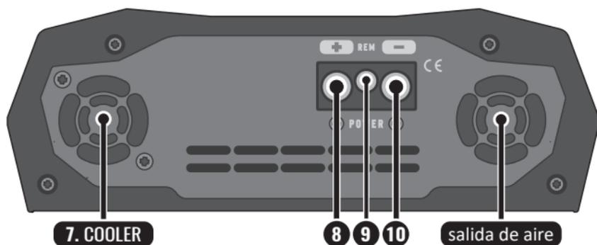
**7. COOLERS:** Proporciona enfriamiento para el amplificador. Realice la instalación en un lugar ventilado, sin obstruir las entradas y salidas de aire.
