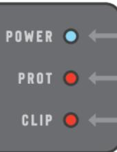
**POWER (LED azul):** Indica o funcionamento do amplificador quando aceso.
