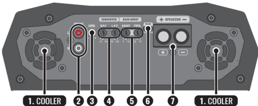
**1. COOLER:** Proporciona enfriamiento para el amplificador. Realice la instalación en un lugar ventilado, sin obstruir las entradas y salidas de aire.
