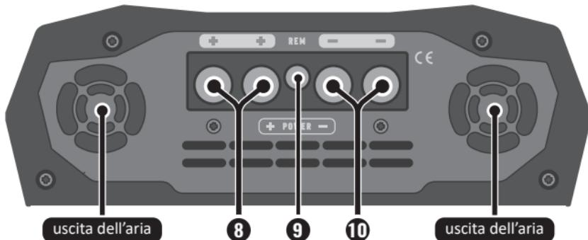
**8. CONNETTORE DI ALIMENTAZIONE POSITIVO:** Collegare al terminale positivo della batteria usando un cavo di almeno **00 AWG** con un fusibile/interruttore il più vicino possibile alla batteria.
