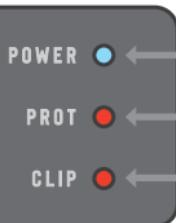
**POWER (LED azul):** Indica el funcionamiento del amplificador cuando está encendido.
