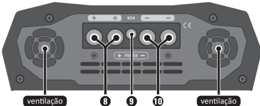
**8. CONECTOR DE ALIMENTAÇÃO POSITIVO:** Conecte ao terminal positivo da bateria através de um cabo de no mínimo **70mm<sup>2</sup>** com um fusível/disjuntor o mais próximo possível da bateria.
