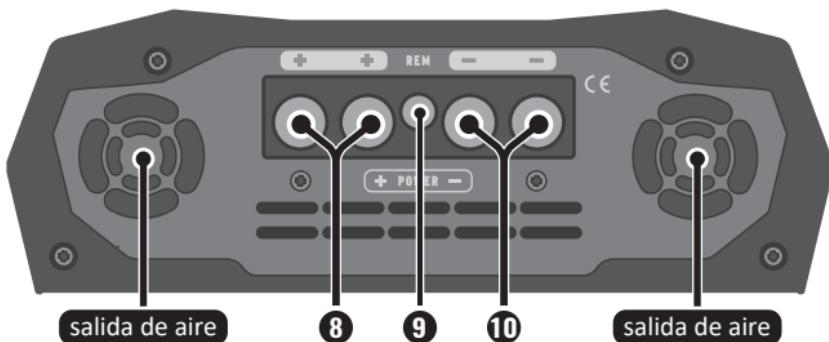
**8. CONECTOR DE ENERGÍA POSITIVA:** Conéctelo al terminal positivo de la batería con un cable de al menos **70mm<sup>2</sup>** con un fusible/disyuntor lo más cerca posible de la batería.
