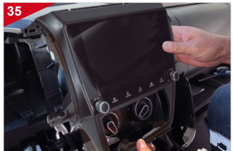
35 Lösen Sie das Original-Radio oder den Naviceiver im Armaturenbrett. Je nach installiertem Gerät variiert die entsprechende Methode.
