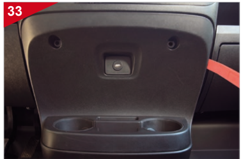
33 Hebeln Sie die komplette Abdeckung samt Getränkehalter heraus.
