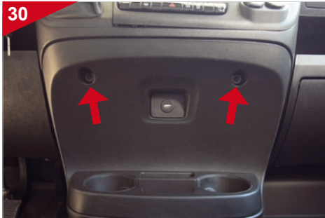
30 Entfernen Sie die beiden Schrauben der Abdeckung an der unteren Mittelkonsole.
