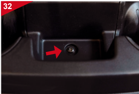
32 Entfernen Sie die Schraube unter der Gummieinlage.
