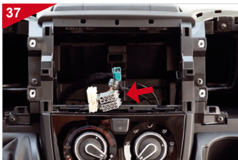
Stecken Sie die beiden ISO-Stecker entsprechend in die ISO-Buchsen (B und D) der beiliegenden Kabelbäume des Verstärkers ein.
