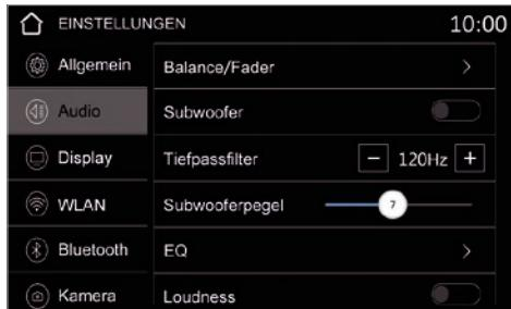
**Subwoofer** aktiviert die SUB1/SUB2 Vorverstärkerausgänge. Unter **Tiefpassfilter** kann deren Trennfrequenz eingestellt werden, d.h. alle Frequenzen oberhalb werden herausgefiltert. Darunter können Sie den **Subwooferpegel** einstellen.
