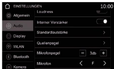
Unter **Mikrofon** können Sie wählen, welches Mikrofon für die Freisprechfunktion verwendet werden soll. **F** ist das interne Mikrofon am Bedienpanel und **R** ist das externe Mikrofon, welches hinten am Gerät angeschlossen ist.
