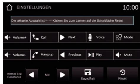
Sofern Ihre Lenkradfernsteuerung richtig am Gerät angeschlossen wurde, können Sie hier die einzelnen Funktionen dem Gerät anlernen. Sobald Sie alle Funktionen zugeordnet haben, verlassen Sie das Menü mit **Save/Exit**.
