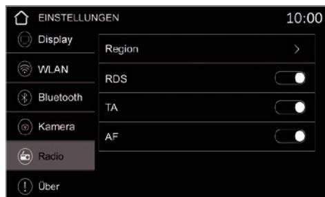
Mit **AF** wechselt das Radio zu einer alternativen, besseren Frequenz des Senders im Netzwerk, falls das Empfangssignal zu schwach ist und eine alternative Frequenz vorhanden ist.
