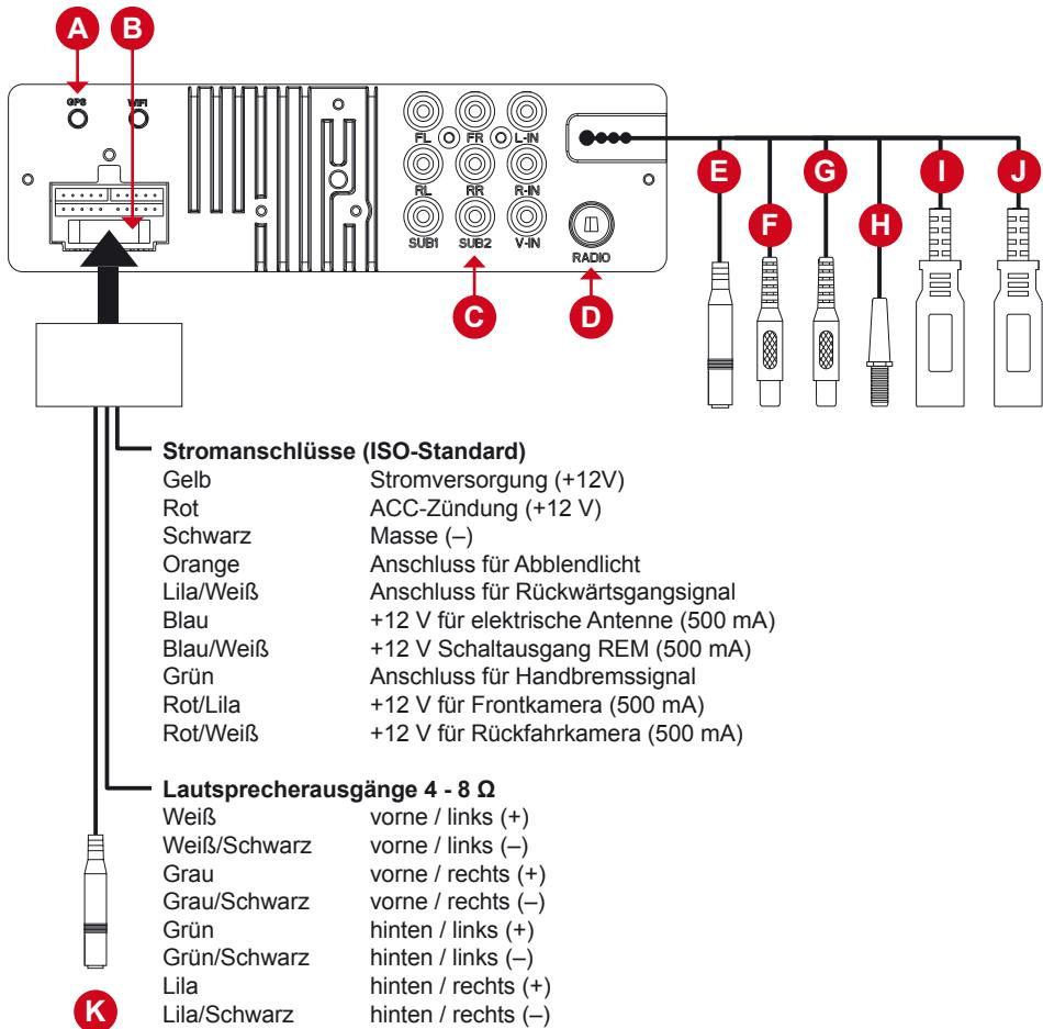
Falls Ihr Fahrzeug keinen passenden ISO-Systemstecker besitzt, müssen Sie den beiliegenden 16-pol ISO-Doppelstecker verwenden und wie oben beschrieben die entsprechenden Anschlüsse an den offenen Kabelenden anschließen.
