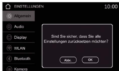
Unter **Werkseinstellung** können Sie alle Einstellungen des Geräts auf die Werkseinstellung zurücksetzen. **Vorsicht**, dadurch werden alle Ihre gespeicherten Einstellungen gelöscht.
