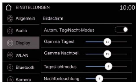
Mit **Autom. Tag/Nacht-Modus** können Sie die Steuerung für den Tag- und Nachtlichtmodus über das angeschlossenen Abblendlichtsignal aktivieren.
