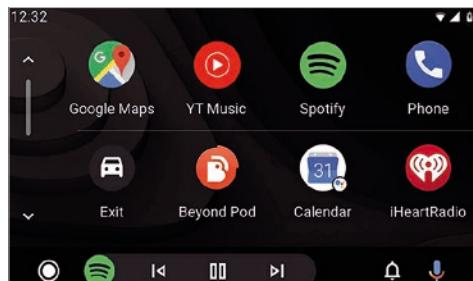
Um Sie **Android Auto** nutzen zu können, müssen Sie Ihr Handy zunächst per USB-Ladekabel oder per Bluetooth mit dem Gerät verbinden (Siehe Seite 18). Dabei muss Bluetooth und WLAN auf beiden Geräten aktiviert sein. Unter Umständen müssen Sie noch die App Android Auto installieren und für diese Verbindung aktivieren.
