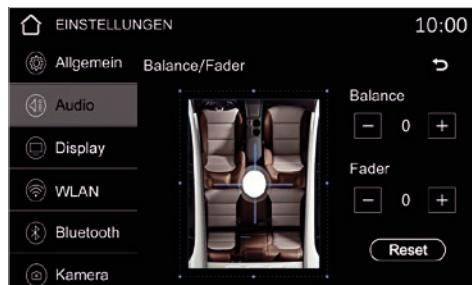
Unter **Balance/Fader** können Sie die Balance der akustischen Bühne zwischen Links und Rechts sowie Vorne und Hinten einstellen.
