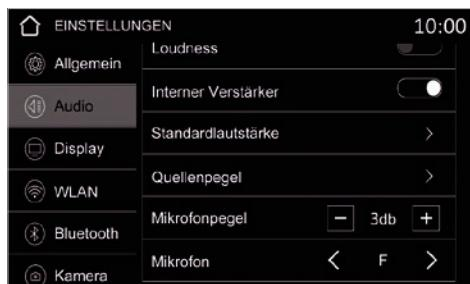
Unter **Mikrofonpegel** können Sie die Laustärke des Mikrofons der Freisprechfunktion mit **- / +** einstellen.
