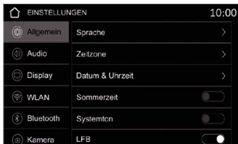
Der Schieberegler neben **LFB** öffnet das Anlernmenü der Lenkradfernsteuerung.
